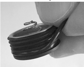
ЗАМЕНА УПЛОТНИТЕЛЬНОГО КОЛЬЦА
