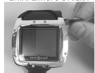
УСТАНОВКА КРЫШКИ БАТАРЕЙНОГО ОТСЕКА
